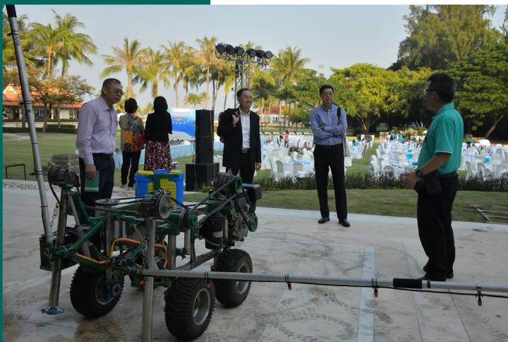
นอกจากนี้ หุ่นยนต์อารักขาพืช แบบ mobile robot ยังสามารถนำมาชุดเชยเพื่อการใช้สารเคมีได้อีกด้วย โดยมีแขนกลอัดพ่นสาร 2 แขน กำหมุนได้หลากหลาย ใช้ได้ทั้งไนโตรเจนพุ่ม และ พืชไร่ พืชผักที่มีความสูงและขนาดที่แตกต่างกัน และสามารถทำการกิจในการตัดหญ้า และฉีดพ่นไปพร้อม ๆ กันได้ โดยสามารถสั่งงานฉีดพ่นแบบต่อเนื่อง หรือแบบไม่ต่อเนื่อง (เฉพาะจุด) ได้
