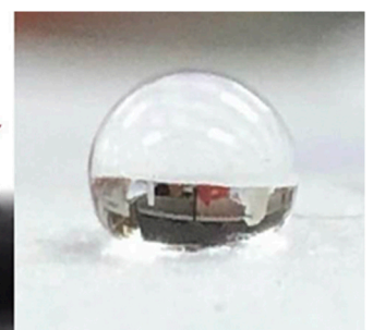
รูปแสดงการหยดน้ำลงบนพื้นผิวผ้า มีมุมสัมผัส (contact angle) สูง ซึ่งแสดงถึงสมบัติการสะท้อนน้ำที่ดี
