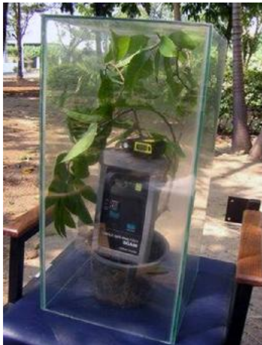
การทดสอบการดูดซับก๊าซคาร์บอนไดออกไซด์ในครอบกระจกควบคุม
